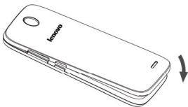
图 3 安装手机后盖
