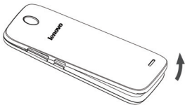
图 1 拆卸手机后盖
